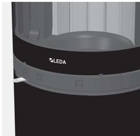
obr. 4.9 Šoupátko spalovacího vzduchu zcela doleva – spalovací vzduch zcela zavřený
