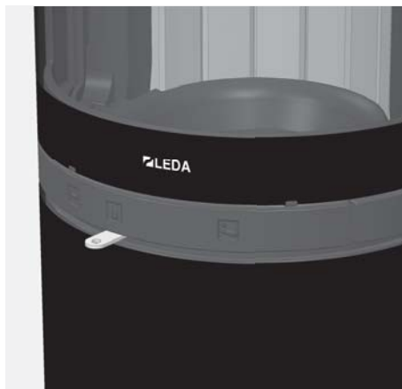
obr. 4.10 Šoupátko spalovacího vzduchu uprostřed – poloha při normálním topení („jmenovitý tepelný výkon“).
