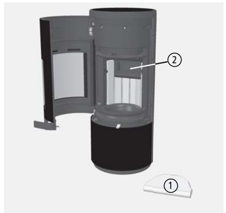
obr. 4.16 Vstup do šachty topného plynu, přídržný úhelník
