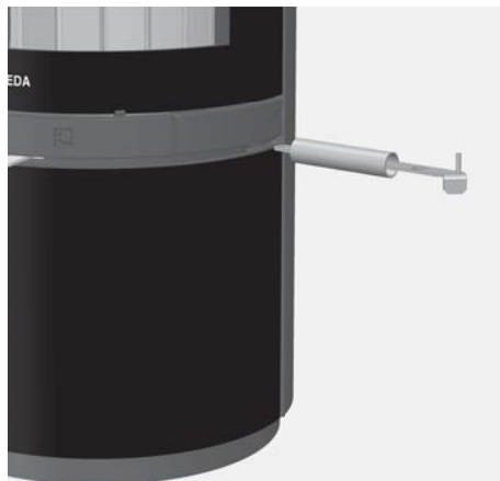
obr. 4.3 Uzávěr dveří a ovládací rukojeť („studená ruka“)
